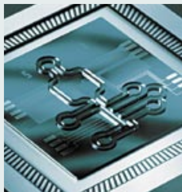
Biochipsen bruges til sortering af celler og til at analysere DNA fra cellerne. En sådan chip kan bruges til hurtig diagnostik.
