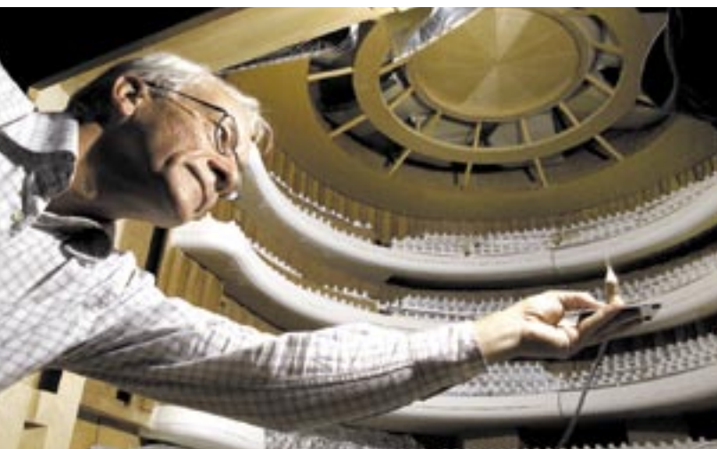
Jens Holger Rindel i en opera-model med en elektrisk gnistkilde, der skal give et knald til akustiske målinger.
