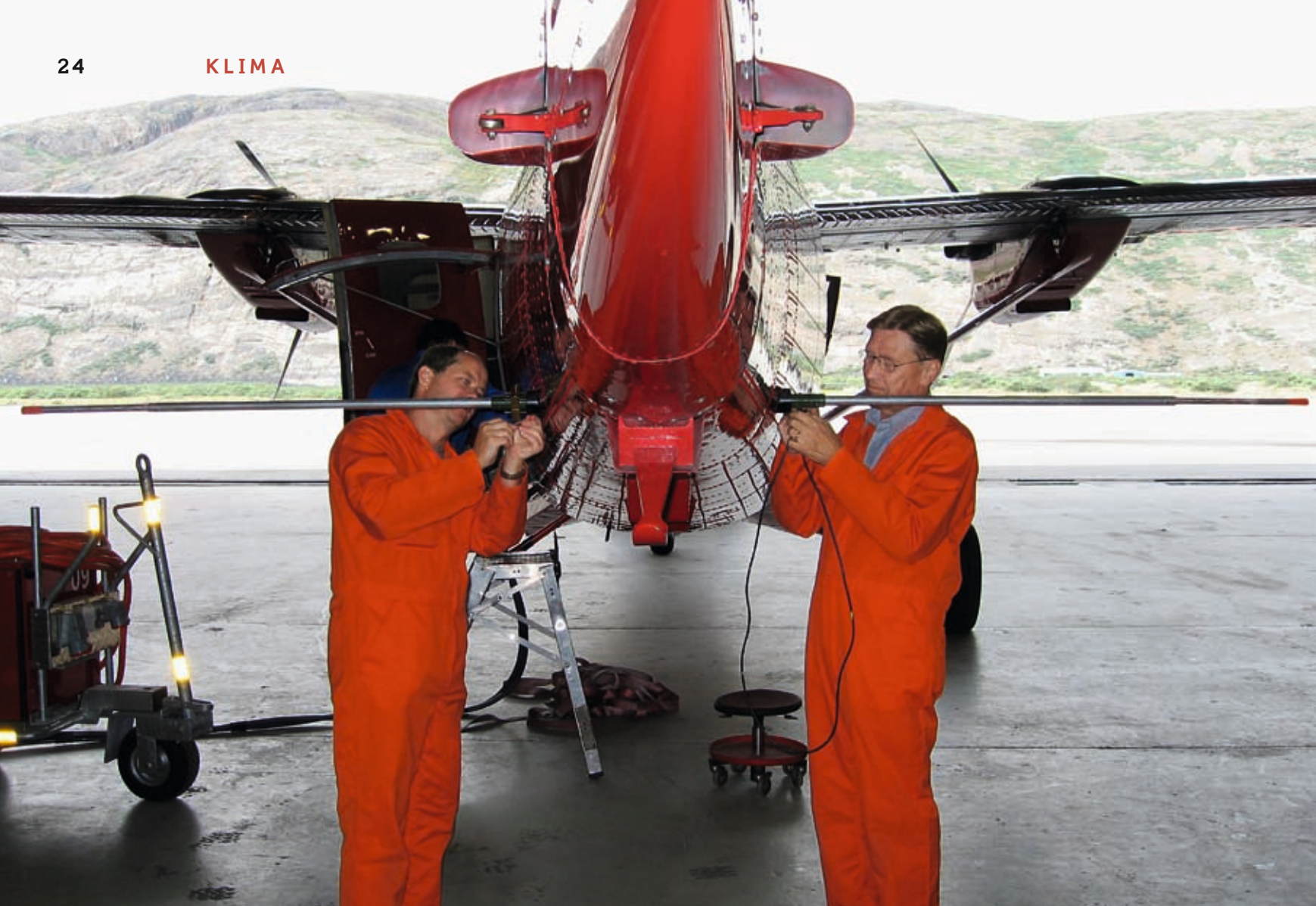
Steen Savstrup Kristensen og Erik Lintz Christensen (t.h.) i færd med at montere antennen til is-radaren på flyet.
