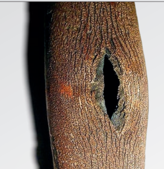
Stålrør med højt krom-indhold har dannet Z-fase ved 650 °C og er brudt sammen.
