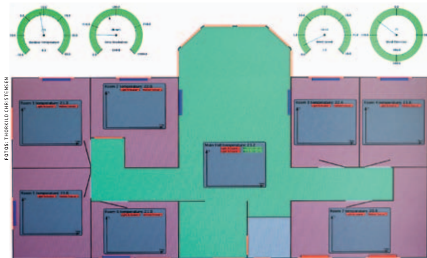
På en monitor kan man aflæse bygningens 'tilstand', f.eks. om døre og vinduer er åbne og se, hvor varmt der er i de forskellige rum.
