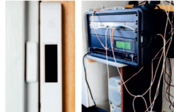
Barakken på Risø DTU er udstyret med sensorer på alle døre og vinduer (billedet i midten). Bygningens elforbrug og -produktion styres af den sorte boks (billedet længst til højre), som også sørger for bygningens kommunikation med elsystemet.
