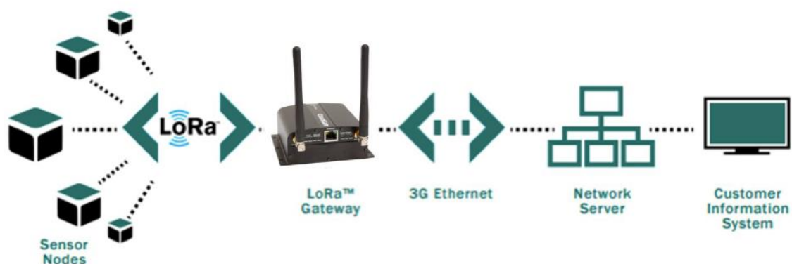
Figur: Model af LORAWAN. Sensor nodes repræsenterer trafiksensoren.
