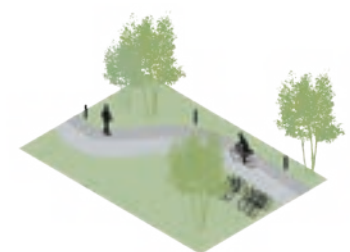
Fællessti for fodgængere og cyklister med differentiering i belægning.
